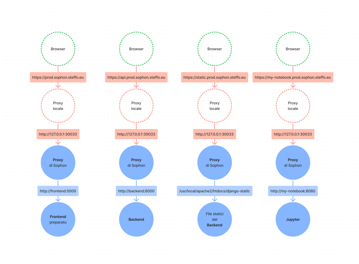
Figura 4.2.7: Schema del reverse proxying di Sophon.
